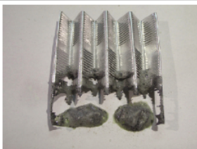
空気に触れると激しく酸化して溶解した
