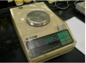
最大1/1000g計測できる 微細な重量計を使用
