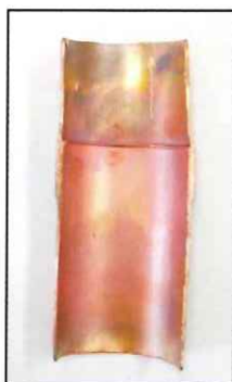
窒素純度 98.0% 窒素流量 6NL/min
